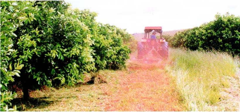
Figura 17 - Roçadeira com abertura lateral, que joga o material vegetal ceifado para baixo da copa das plantas cítricas.
