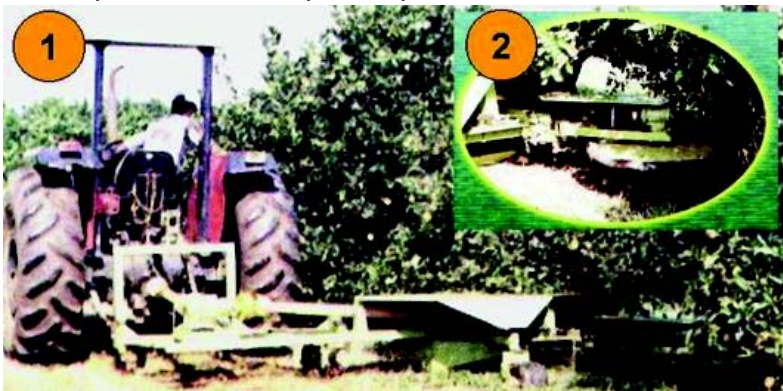
Figura 18 - Roçadeira lateral com dispositivo para recuo quando do contato com o tronco das plantas cítricas, possibilitando a ceifa nesta região.
