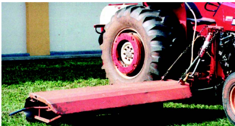
Figura 12 - Barra lateral aplicadora de herbicidas acoplada na parte medial (entre as rodas dianteira e traseira) do trator.
