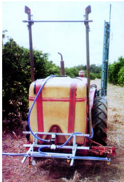
Figura 13 - Barra central aplicadora de herbicidas nas entrelinhas dos pomares cítricos.
